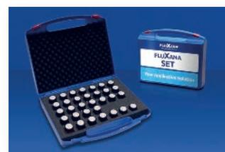
Mais aussi des **sets de calibration** (e.g. ciment, matières premières, cendres, verres et bien plus) mais aussi des **moniteurs de correction de dérives, échantillons de contrôle et échantillons LOC**.
