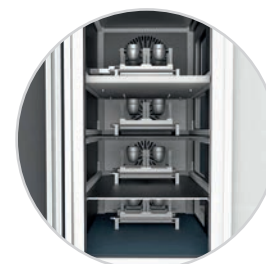
optionale Erweiterungsmodule für den Dauerbetrieb für bis zu 16 Proben
