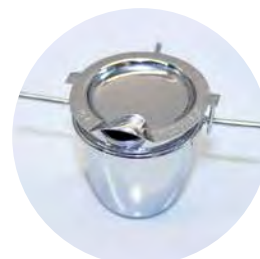
Verwendung von Deckeln zur Analyse flüchtiger Elemente
