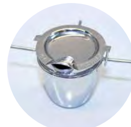
Speciale toepassing: gebruik van deksels voor vluchtige elementen
