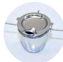
Utilisation de couvercles et analyse des éléments volatils
