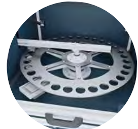
Pesée automatique jusqu'à 30 échantillons
