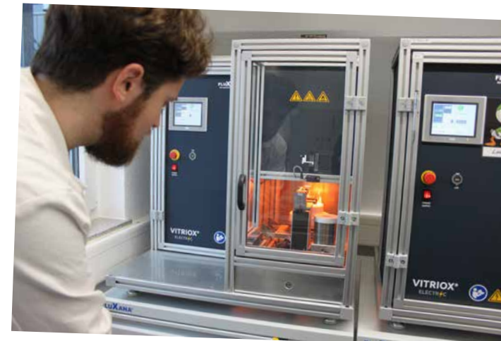
Ein Labormitarbeiter beobachtet das Abgießen der Schmelze.
